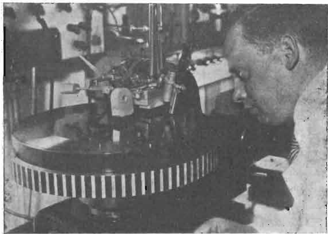
Fig. 2 - La macchina per incidere il suono sul disco. Si vede chiaramente la testa a incidere, il dispositivo stroboscopico per il controllo continuo della velocità. L'operatore in questo momento sta controllando visualmente se l'incisione è ben riuscita.
